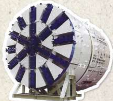
「港北行きトンネル」を掘るシールドマシン (発注者:首都高速道路(株))
