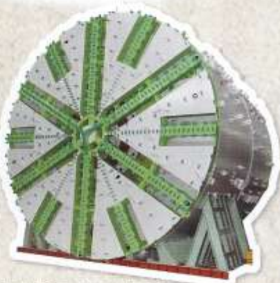
「青葉行きトンネル」を掘る シールドマシン(発注者:横浜市)
