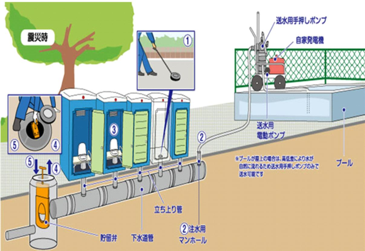
※ 通常時 7つの「マンホールの蓋」は地盤面から約 10 cm 下に埋設しています。なお、機材は防災備蓄庫に保管されています。
